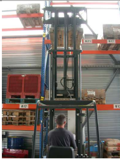
Figure 8 : mise en situation d'un cariste utilisant un chariot groupe 3 : situation ergonomique difficile, palette en hauteur à plus de 5m, face à un toit extrêmement lumineux et éblouissant rendant très difficile l'appréciation des distances.
